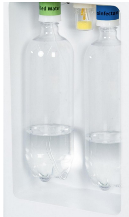
A tisztavíz-palack és a fertőtlenítőszeres palack
